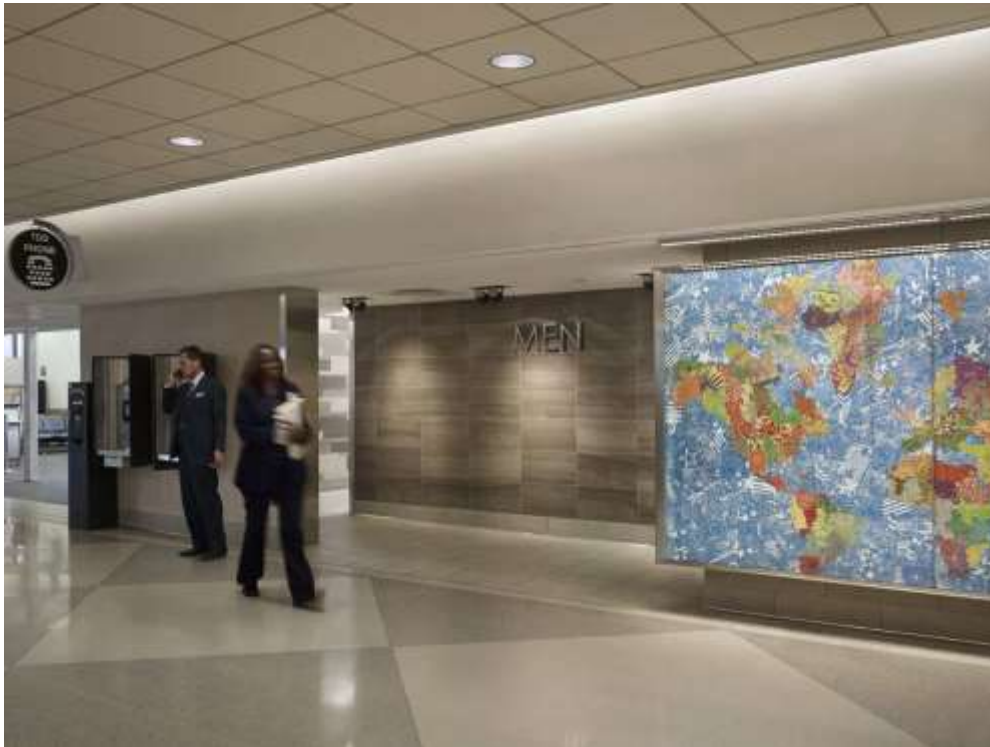
شكل رقم ( 2 ) يوضح الفكرة الرئيسية لمداخل دورات المياه بدون أبواب فى مطار فيلادلفيا الدولى ، فإستخدام الأبواب مقتصر على مستخدمى الكبائن الداخلية فقط لتقليل إنتقال البكتيريا بين المستخدمين
