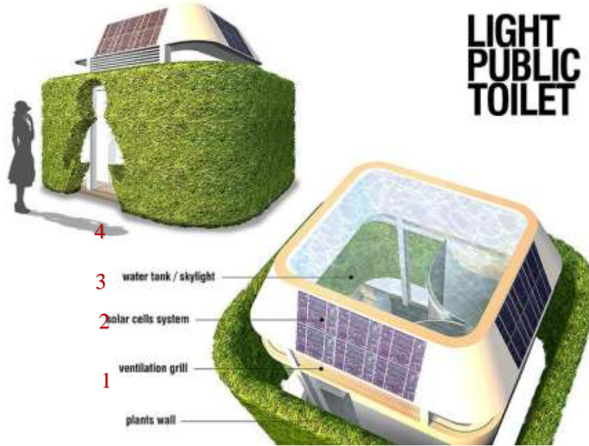
شكل رقم ( 24 ) يوضح التصميم المقترح لدورة المياه الصديقة للبيئة
