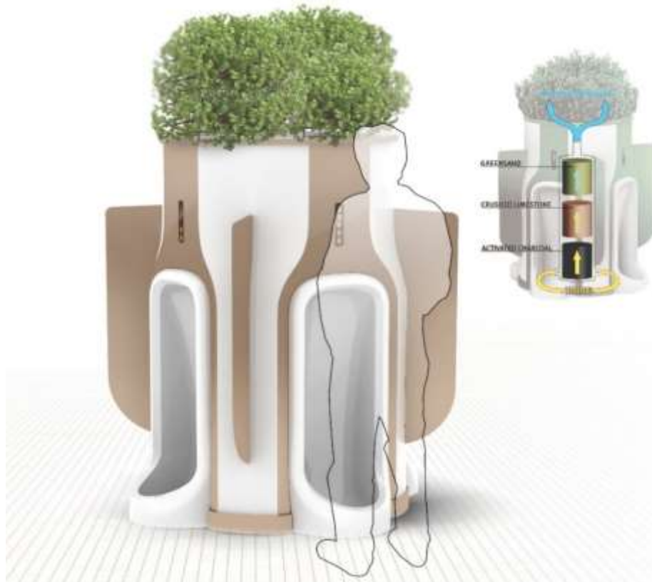
شكل رقم ( 23 ) يوضح عملية تحويل البول إلى مياه صالحة للرى :-
